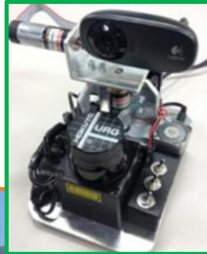
PTカメラを移動ロボットに設置し、移動ロボットが旋回を行うことなく操縦者の見たい方向にカメラを向けることができる。
