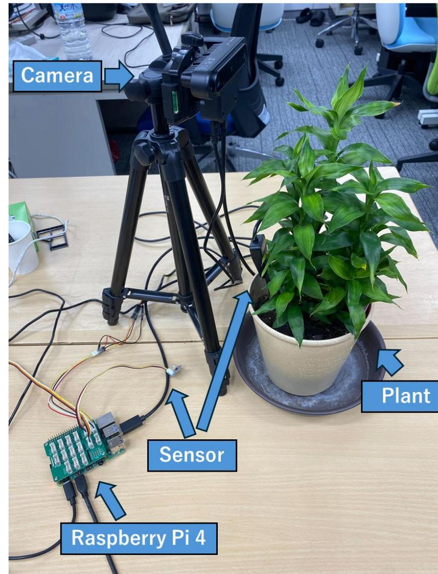
Raspberry Pi 4 を用いた Robotized Plant を中心に、センシングによる内的状態とカメラによる外的状態の情報から、発声により育成者に世話を促す。
